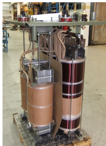
15A P-spole , 200kVA 22000+2-4x2,5% /240V
