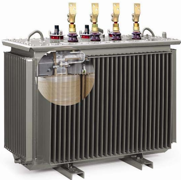
Bilde 2 PowerSafe [6] Fordelingstransformator med korte forbindelser innvendig og lave strømtettheter, sikrer god mekanisk styrke . Kortslutningstest utført etter IEC60076-5 førte til kun 0,45% endring av reaktansen.
