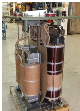
15A P-spole , 200kVA 22000+2-4x2,5% /240V
